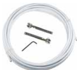
000880 Kit pasamanos compuesto de 10 metros de cable 7x7 con cubierta en PVC de 4mm, 2 terminales de montaje (1 derecho/1 izquierdo), 2 mordazas roscadas con tuercas y 6 tornillos hexagonales de fijación, incluida llave de montaje.
