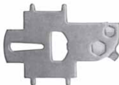
000109 Llave multiuso en acero inoxidable, con destornillador, llave para tuercas de 8 y 11 mm, abre grilletes y abridor para botellas.
