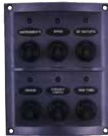
011126 Panel estanco de 6 interruptores con led indicador, fabricado en plástico ABS de alta resistencia, con capuchón de neopreno y fusibles intercalados tipo automóvil. Se suministra con 28 letreros adhesivos. Dimensiones: 110x125 mm.
