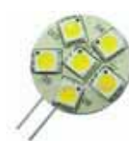
Bombillas de 6 LEDs G-4. Voltaje 10-30V. Consumo 0,15 Amp. Diámetro 23mm.
