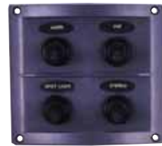
011125 Panel estanco de 4 interruptores, fabricado en plástico ABS de alta resistencia, con capuchón de neopreno y fusibles intercalados tipo automóvil. Se suministra con 28 letreros adhesivos. Dimensiones: 110x100 mm.
