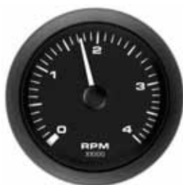
Cuentarrevoluciones. Anclaje 87mm. Diámetro exterior 96mm. La versión diesel con conexión a la toma E del alternador.
