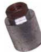
051085 Anodo tipo perno con tuerca Jet Castoldi . 22x24mm. Rosca M-10x15. Peso 0,068kg.
