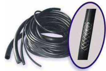
050313 Manguera especial para trasvase de combustible, resistente a los aceites. Se suministra en rollos de 10 y 100mts. Diámetro interior 8mm.
