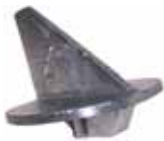
050877 Anodo aleta corta para fueraborda 55hp. Rosca M10x28.
