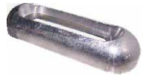
051193 Anodo para atornillar, pletina de acero interior con un agujero sesgado. Medidas 195x65x37mm.
