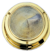
Plafón de montaje en superficie. Lámpara 10W/12V. Diámetro del cristal 102 mm, diámetro total 140 y altura 40 mm. 010209 Plafón en acero inoxidable. 010210 Plafón en bronce. 011685 bombilla recambio
