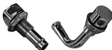
En latón cromado con salida recta de diámetro 15 mm. y 12 mm. de longitud de rosca. 020172 recto 020173 curvo
