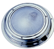
Plafón de montaje en superficie. Lámpara 10W/12V. Diámetro del cristal 76 mm, diámetro total 111 mm. 010205 Plafón en acero inoxidable. 010206 Plafón en bronce. 011648 bombilla recambio
