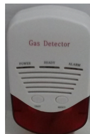
090352 Detector de gas de un captador, alimentado a 12V. Tiempo de disparo menos de 20 segundos y nivel de disparo al 10%. Produce una alarma sonora y luminosa. Montaje sobre mamparo.
