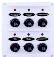
011141-LD Panel estanco fabricado en Plástico ABS de color blanco con 6 interruptores con LED's indicadores y con capuchón de Neopreno. Se suministra con 28 letreros adhesivos. Dimensiones 125,5x109,4mm.
