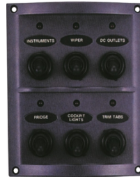
Panel estanco con led indicador, fabricado en plástico ABS de alta resistencia, con capuchón de neopreno y fusibles intercalados tipo automóvil. Se suministra con 28 letreros adhesivos.
