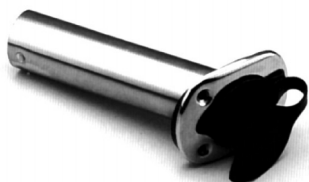
050510 Cañero empotrable fabricado en acero inoxidable y tapón en PVC. Diámetro interior 47mm. Longitud del tubo 240mm
