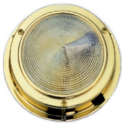
Plafón de montaje en superficie. Lámpara 10W/12V. Diámetro del cristal 76 mm, diámetro total 111 mm. 010205 Plafón en acero inoxidable. 010206 Plafón en bronce. 011648 bombilla recambio
