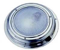
Plafón de montaje en superficie. Lámpara 15W/12V. Diámetro del cristal 127 mm, diámetro total 171 y altura 50 mm. 010213 Plafón en acero inoxidable. 010214 Plafón en bronce. 011685 bombilla recambio
